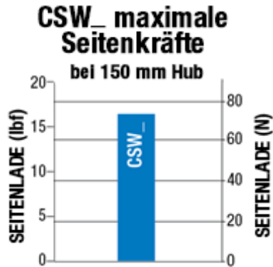
Abbildung 4.2: Seitenkräfte dürfen die durch die Linien im Diagramm dargestellten Maximalwerte nicht überschreiten
