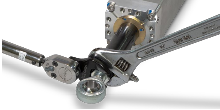
Abbildung 4.3: Halten Sie bei Rundstangen die Schubstange mit einem Schraubenschlüssel an den Abflachungen am Ende der Stange fest, wenn Sie Zubehör, Gestänge oder Last am Antrieb befestigen. Verwenden Sie einen Drehmomentschlüssel, um das Ende der Schubstange am Anschlusspunkt des Antriebs mit der Kontermutter festzuziehen. Die Drehmomentwerte finden Sie in Tabelle 2.2
